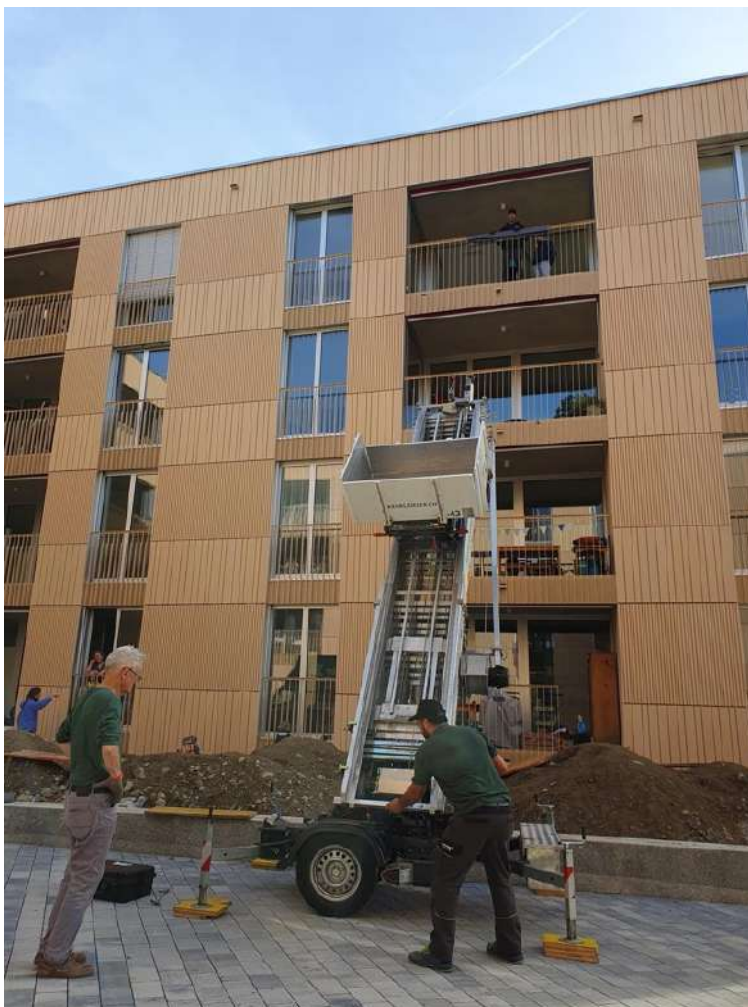
Zügelkran im Innenhof
